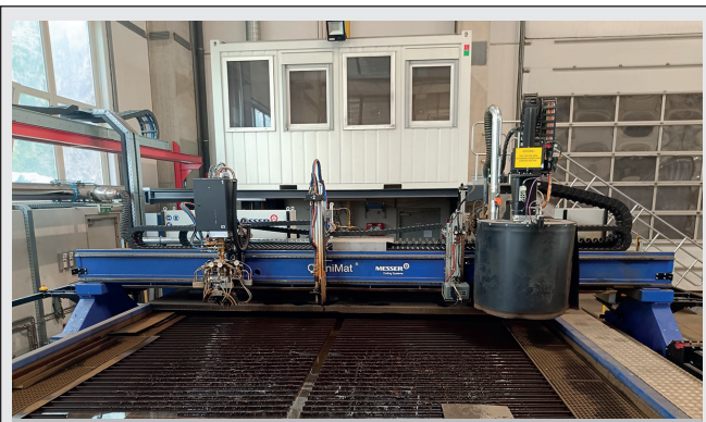
42 Schneiden, Fasen, Markieren, Behälterböden, Rohre – alles auf einer Plattform
