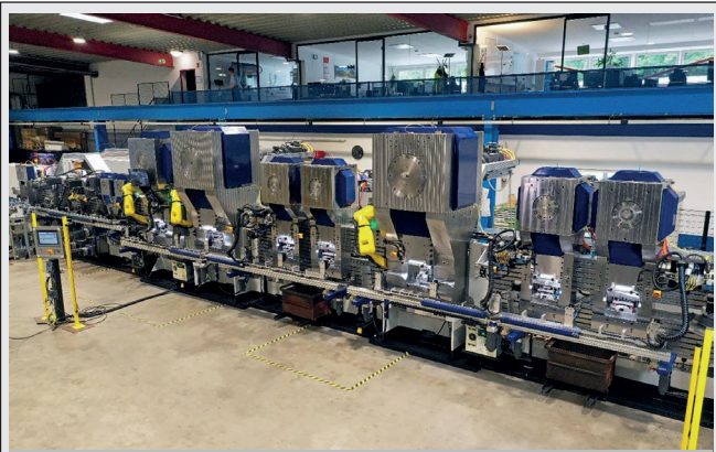
44 Umformanlage mit einer Länge von 25 Metern
