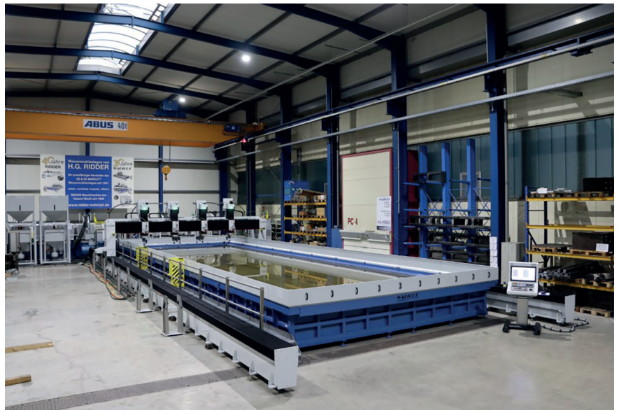
Das ist die neue Wasserstrahlschneidanlage, die in Ilsenburg aufgebaut wird (Bild: Dominik Ridder, H.G. Ridder GmbH)
