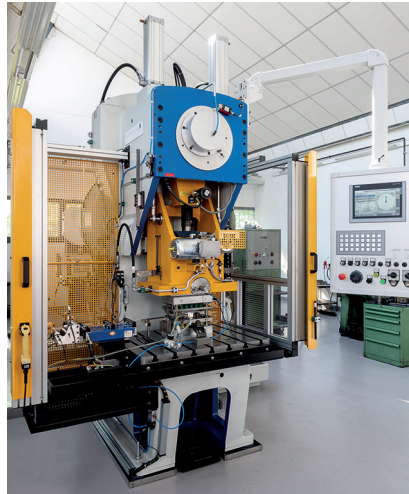
Die Nägeli Swiss AG hat eine 63-Tonnen Umformpresse in Betrieb genommen und erweitert ihre Fertigungskapazität für kleine und mittlere Tiefziehteile
